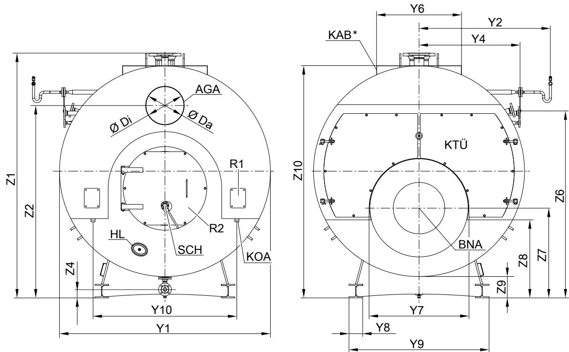
Конструкция с поперечной планкой является серийным исполнением, опциональный вариант опоры котла: Конструкция с поперечной планкой с продольной балкой из широкополочного двутаврового профиля
