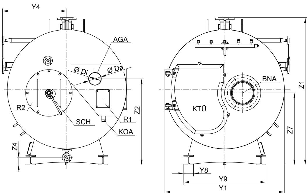
Конструкция с поперечной планкой является серийным исполнением, опциональный вариант опоры котла: Конструкция с поперечной планкой с продольной балкой из широкополочного двутаврового профиля
