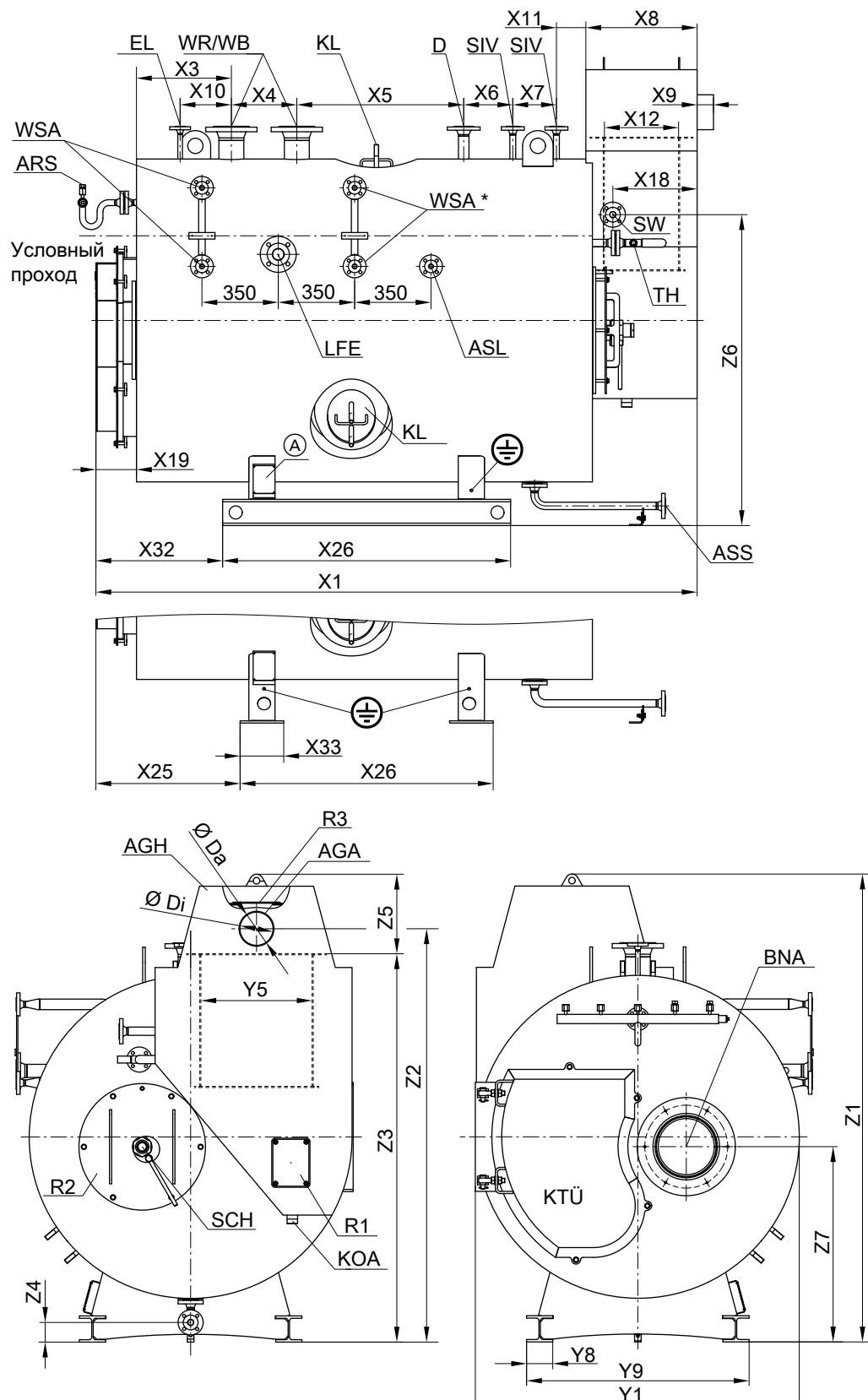
Конструкция с поперечной планкой является серийным исполнением, опциональный вариант опоры котла: Конструкция с поперечной планкой с продольной балкой из широкополочного двутаврового профиля
