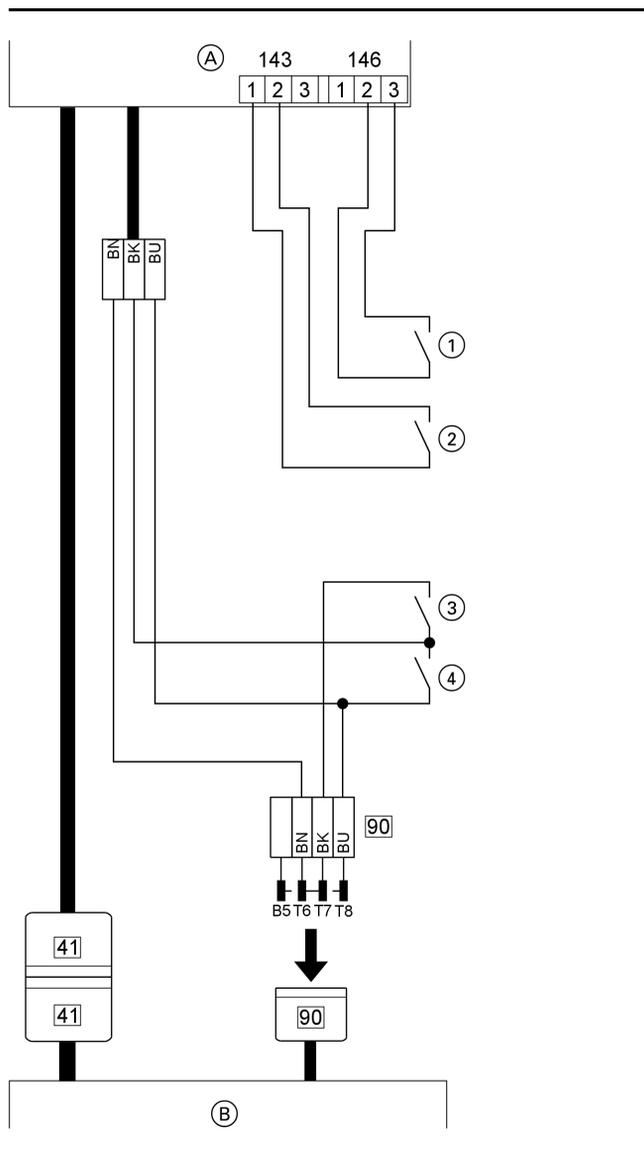
1. Деблокировка котла, дроссельная заслонка откр./загр. (контакт контроллера иерархически более высокого уровня с модуляционным регулятором)
