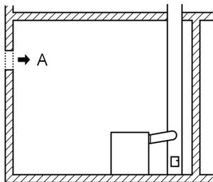
$$A = 150 \text{ см}^2 + 2 \frac{\text{см}^2}{\text{кВт}} \times (\sum \dot{Q}_n - 50 \text{ кВт})$$
