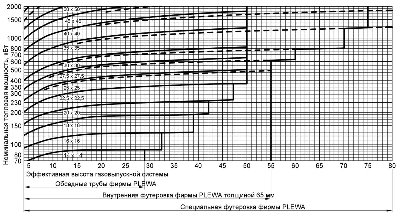
Данная диаграмма может оказаться пригодной и для оборудования других фирм. Однако специализированная фирма, производящая работы, должна проверить, насколько данная диаграмма применима в отношении оборудования иных производителей газораспределительных систем.
